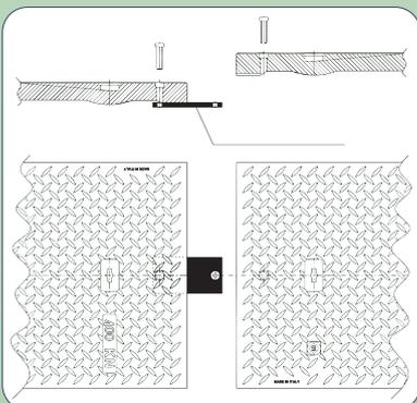
plaque de connexion - verrouillage par vis
